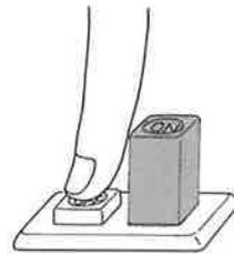
●発光中、またはカーボン電極先端を接触した状態で電源スイッチの「ON」「OFF」を行わない。
